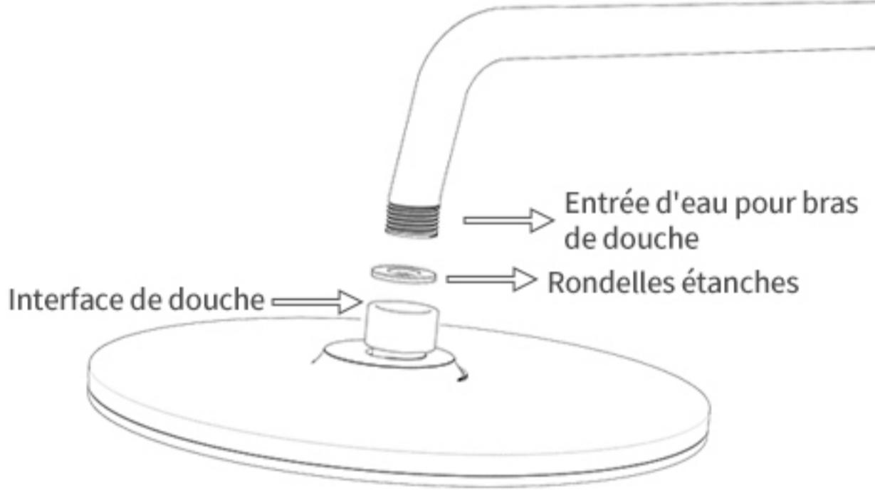
L'interface de la tête de douche est G1 / 2 Interface universelle. Après réception, assurez - vous Il y a une rondelle à l'intérieur de l'interface Il suffit de serrer pour utiliser
