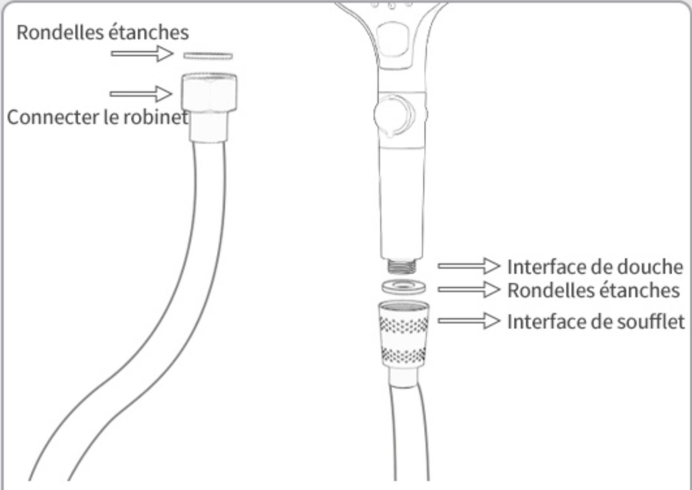
L'interface de douche est universelle Interface pouvant être vissée directement Faites pivoter le tube de douche dans le sens horaire.
