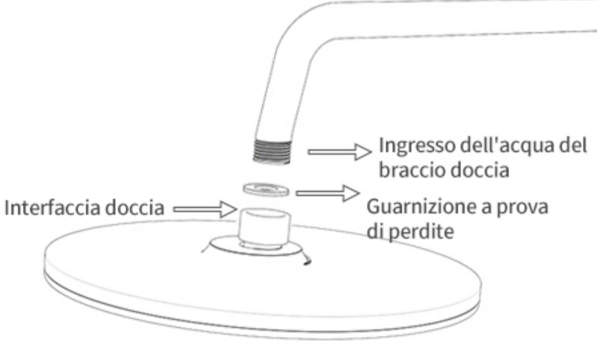
L'interfaccia del soffione doccia è un G1/2 interfaccia universale. Dopo averlo ricevuto, assicurarsi che c'è una guarnizione all'interno dell'interfaccia e semplicemente avvitarlo per usarlo
