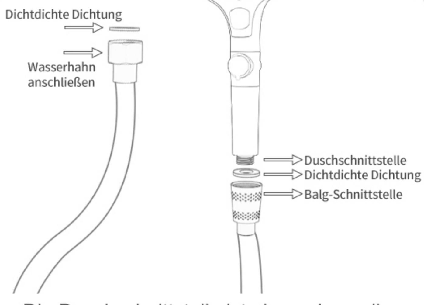
Die Duschschnittstelle ist eine universelle Schnittstelle, die direkt angezogen werden kann im Uhrzeigersinn mit dem Duschröhr.
