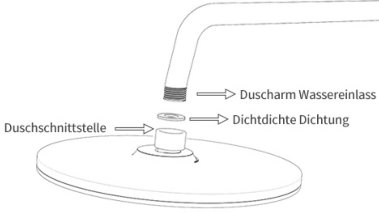
Die Schnittstelle des Duschkopfes ist ein G1/2 universelle Schnittstelle. Stellen Sie nach Erhalt sicher, dass es eine Dichtung innerhalb der Schnittstelle gibt und einfach anschrauben, um es zu verwenden.
