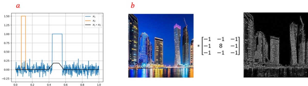
איור 5.1 (a) קונבולוציה חד ממדית בין שתי פונקציות: x_1 הינו מלבן בגובה 1 עם רעש קטן (כחול), ו- x_2 הינו גרעין קונבולוציה מלבני שרץ על פני כל הישר (כתום). פעולת הקונבולוציה (שחור) בודקת את החפיפה בין הסיגנל לבין הגרעין, וניתן לראות שאכן סביב x = 0.5 \pm 0.1 יש אזור עם הרבה חפיפה. (b) קונבולוציה דו ממדית למציאת קווי מתאר של בתוך תמונה.
