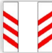
מפגש מסילת ברזל במרחק של כ-300 מטר אלא אם כן צוין אחרת
