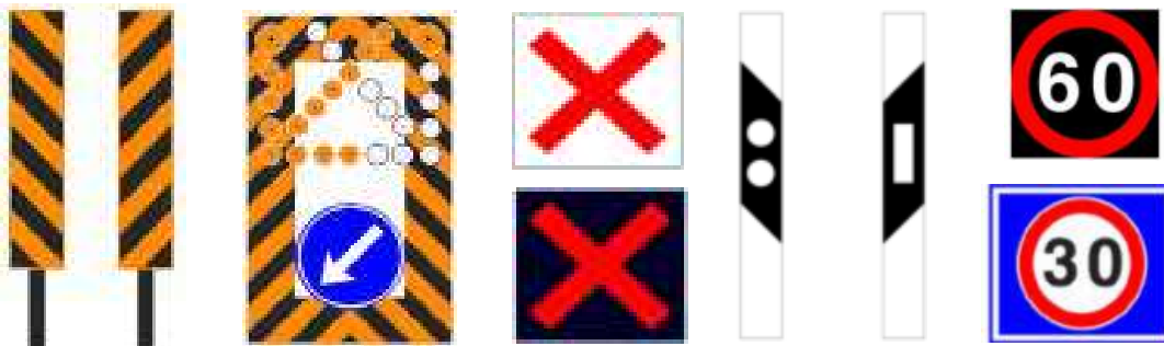
התמרחים חייבים להיות מוארים או זוהרים על מנת לאפשר זיהוי כאשר הראות הלקויה
