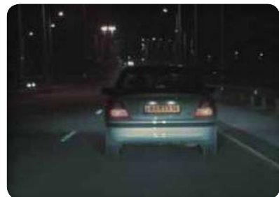
כאשר אלומת האור מאירה את חלקו האחורי של הרכב מלפנים יש לעמעם את האורות
